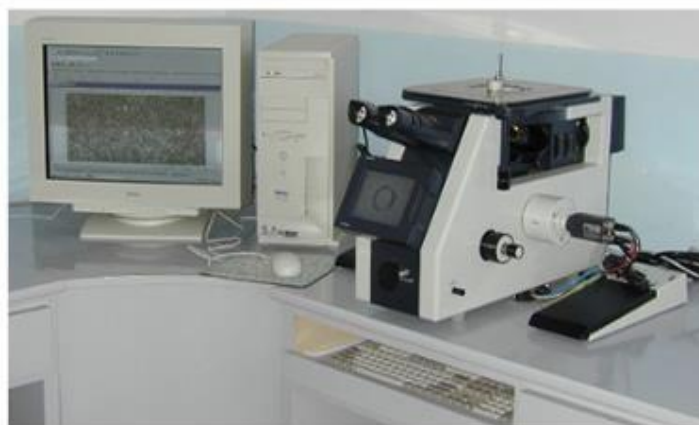
Figure 5.13 System d'analyse d'images LECO 500
